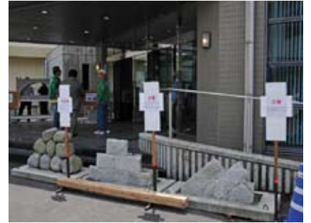
会場には石橋に関する展示物が置かれた。上は木製の支保工模型。下は石材を使った、「野面積」「布積」「谷積」のサンプル
