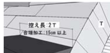
壁石の控え長と合端(あいば)加工
